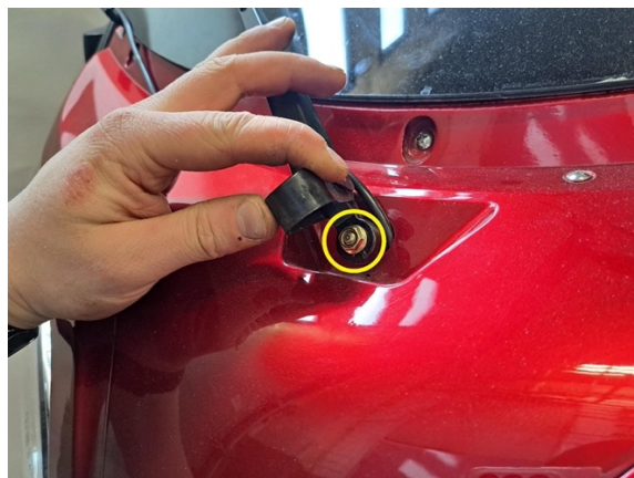
Irrota tuulilasinpyyhkijän kiinnitysmutteri. (hylsy 10 mm).
