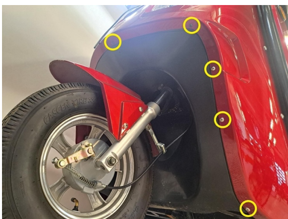
Irrota etusisälokasuojassa etukatetta kiinni pitävät kiinnitysruuvit molemmilta sivuilta. (ristipäämeisseli ph2).
