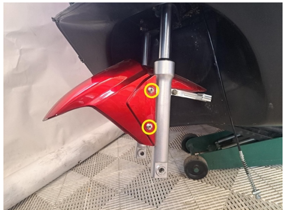
Irrota etulokasuojan kiinnitysruuvit. (ristipäämeisseli ph2)
