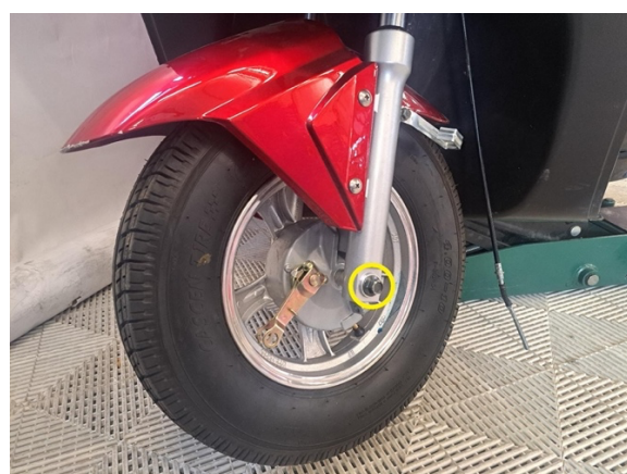
Irrota etupyörän akseli. (kiintoavain 17 mm, 14 mm).
