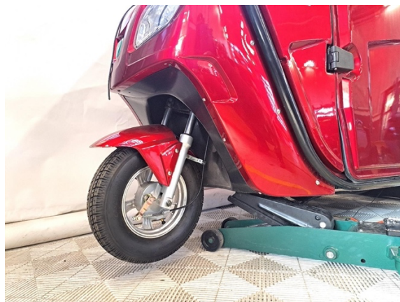
Nosta laitteen etuosa ilmaan.
