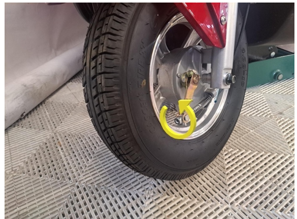
Irrota etujarruvaijerin säätömutteri. (kiintoavain 14 mm).
