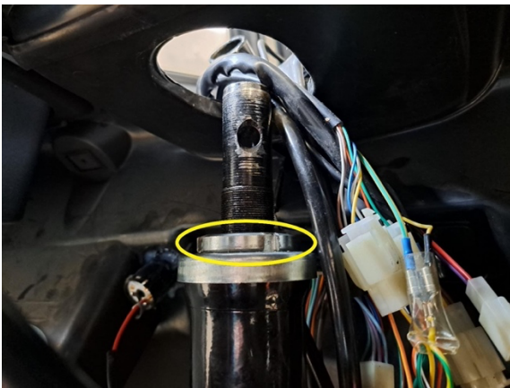
Irrota ohjauslaakerin kiristysmutteri. (siirtoleukapihdit). Kannattele ohjausvartta samalla kun irrotat kiristysmutteria, ettei ohjausvarsi pääse putoamaan.
