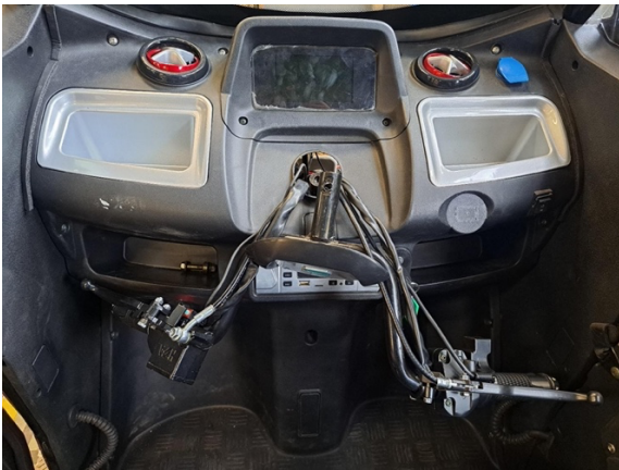
Nosta ohjaustanko pois paikoiltaan.
