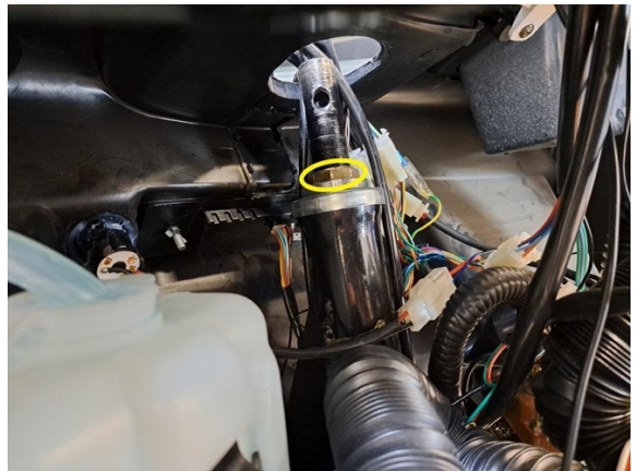
Irrota ohjausvarren kiinnitysmutteri. (kiintoavain 32 mm).
